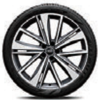
アルミホイール 5Vスポークダイナミックデザイン グラファイトグレー 8.5J×21+255/35R21タイヤ ○オプション Audi A6 / A6 Avant ※55 TFSI quattro S lineは除く。
